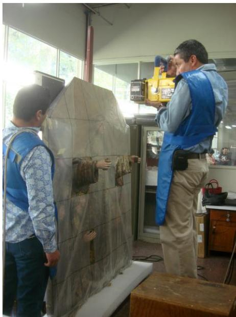
En esta fotografía se observa como se lleva a cabo la toma de radiografías digitales, se puede ver que la obra fue cubierta con un plástico previamente cuadrículado con las medidas del chasis por el frente y por la parte de atrás para llevar un orden de las tomas radiográficas y para poder facilitar el ensamble posterior al
